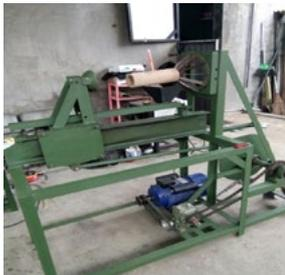
Mesin I (Mesin Pemecah dan Pengirat Bambu)
